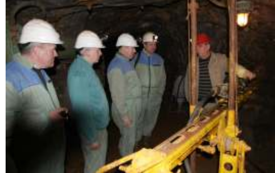
Ein pressluftgetriebener Bohrhämmer mit dessen Hilfe sich das Bohrgestänge ins Gestein „frisst“, insofern gesprengt werden soll
